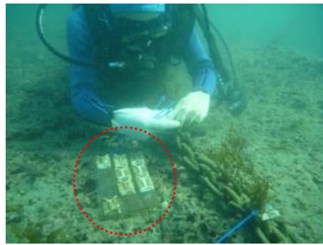
写真17 Kamo モデル設置作業(シートは安定している)
