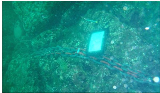
写真9 検証地点で一冬越したチェーン・アンカー
